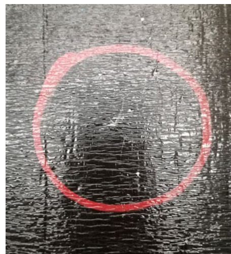
Test per la Determinazione della Resistenza alla Grandine di membrana flessibile secondo la norma UNI EN 13583:2012
